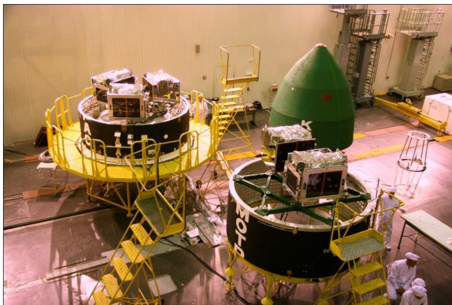
Рис. 4. Проведение сборки головных частей на пусковом комплексе
