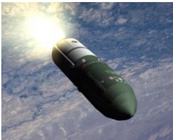
Рис. 1. Выведение группы КА на орбиту при помощи универсальной КГЧ РН «Днепр»
