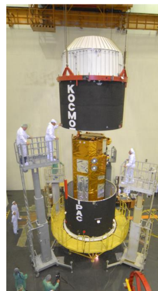
Рис. 3. Испытания КГЧ на вибропрочность и функционирование системы отделения космических аппаратов IRIDIUM
