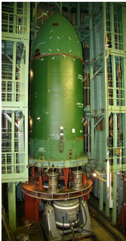
Рис. 3. Испытания КГЧ на вибропрочность и функционирование системы отделения космических аппаратов IRIDIUM
