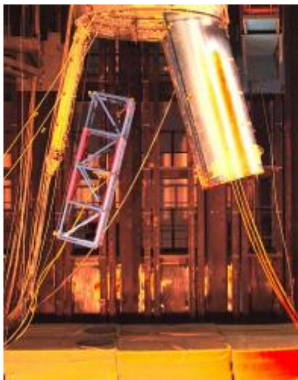
Рис. 3. Испытания КГЧ на вибропрочность и функционирование системы отделения космических аппаратов IRIDIUM
