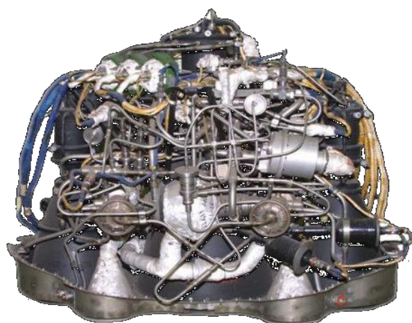
Рис. 6. Блок двигателей лунного взлетно-посадочного модуля блока Е
