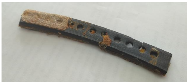
Рис. 2. Фрагмент технологической вставки после испытаний
