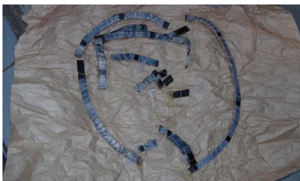
Рис. 5. Дополнительная технологическая вставка после испытаний
