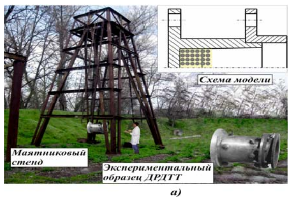
Рис. 7. Маятниковые стенды для испытаний ДРДТТ: а – большой маятниковый стенд с цилиндрической камерой сгорания; б – малый маятниковый стенд в бронекамере
