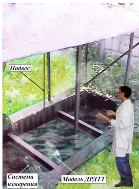
Рис. 9. Стенд для испытания ДРДТТ под водой ложены крупногабаритная ( d = 1 м, L = 2 м, 38
