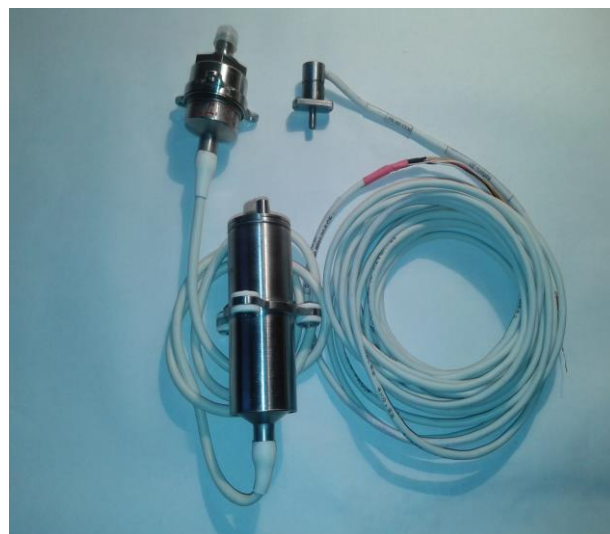
Рис. 1. Сравнительные размеры типовых датчиков давления и датчиков разработки СКТБ с ОП (справа)
