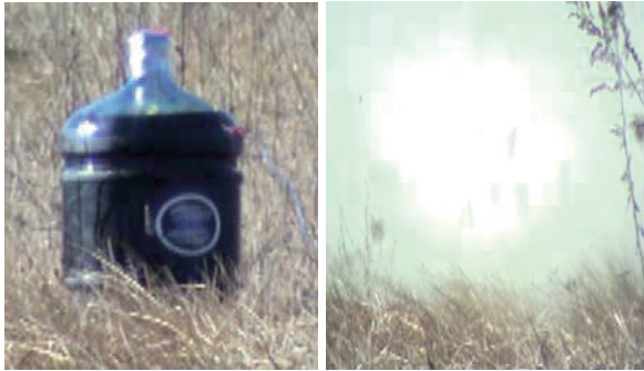
Рис. 3. Подрыв заряда аммонита 6ЖВ в емкости с отработанным трансформаторным маслом
