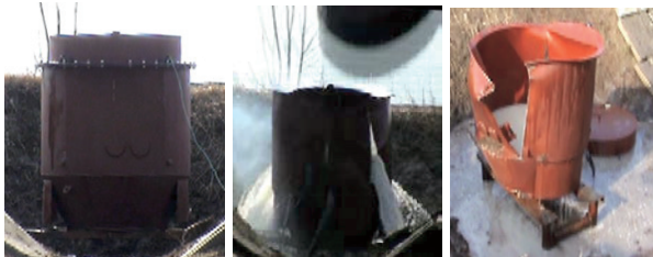
Рис. 4. Верхняя часть трансформатора до, во время и после подрыва заряда ВВ
