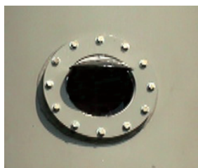
Рис. 8. Разгрузочная мембрана фирмы Elfab после испытаний
