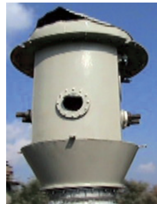
Рис. 10. Верхняя часть трансформатора после испытаний
