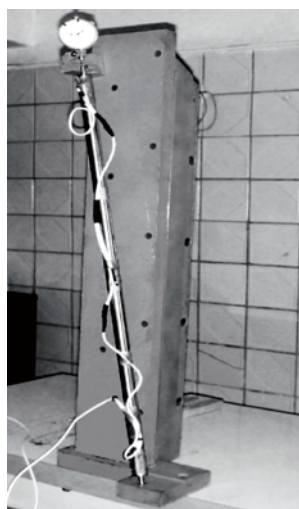
Рис. 2. Стержень-эталон в захватах измерительного устройства
