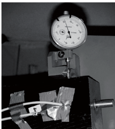
Рис. 5. Способ закрепления индикатора перемещений ИЧ-0,001
