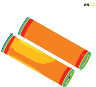
Рис. 7. Распределение напряжений по Мизесу (вид обратной стороны)
