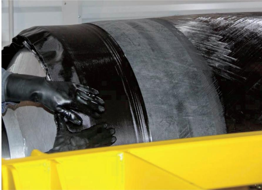
Рис. 11. Намотка узлов стыка
