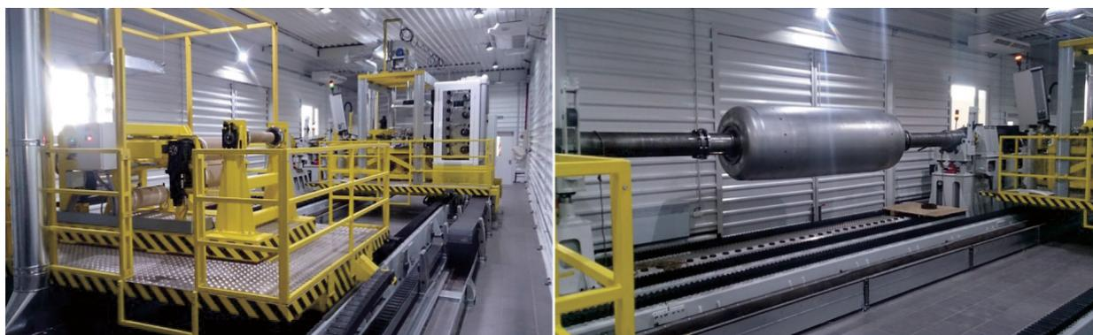
Рис. 1. Намоточный станок с ЧПУ
