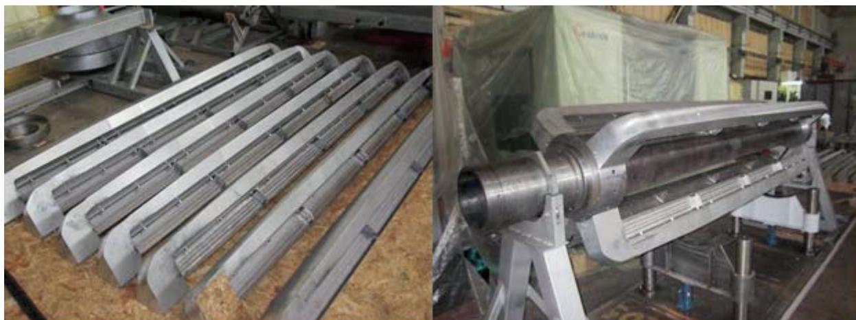
Рис. 9. Сборка оправки
