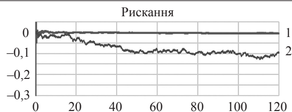
Рис. 8. Кут рискання, який отримано згідно з (5) (лінія 1) та за методом Рунге-Кутта (лінія 2) (напрямок осі X_1 протилежний напрямку дії сили тяжіння)
