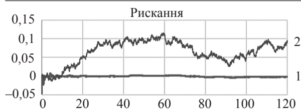
Рис. 23. Кут рискання, який отримано згідно з (5) (лінія 1) та за методом Рунге-Кутта (лінія 2) (напрямок осі Z_1 збігається з напрямком дії сили тяжіння)
