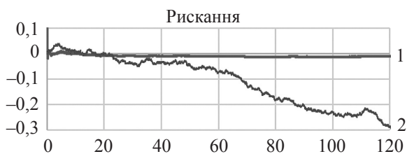
Рис. 17. Кут рискання, який отримано згідно з (5) (лінія 1) та за методом Рунге-Кутта (лінія 2) (напрямок осі Y_1 збігається з напрямком дії сили тяжіння)
