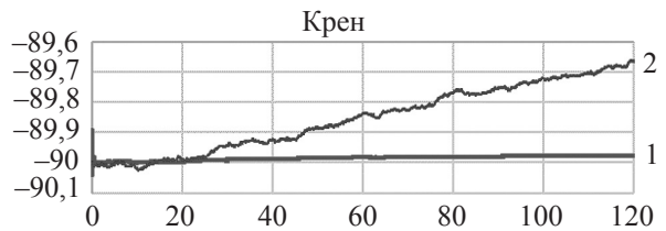
Рис. 19. Кут крену, який отримано згідно з (3) (лінія 1) та за методом Рунге-Кутта (лінія 2) (напрямок осі Z_1 протилежний напрямку дії сили тяжіння)
