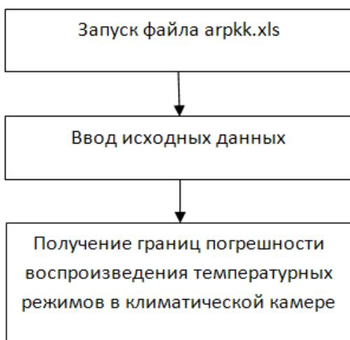
Рис. 3. Структурная схема автоматизированного расчета
