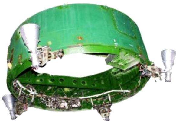
Рис. 5. Жидкостные ракетные двигатели РД864 и РД869
