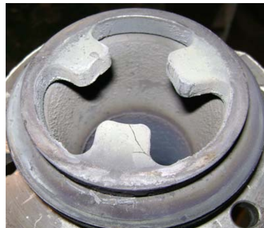
Рис. 15. Состояние диафрагмы после испытаний № 9, 10
