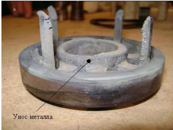
Рис. 11. Места уноса материала при обтекании потоком продуктов сгорания
