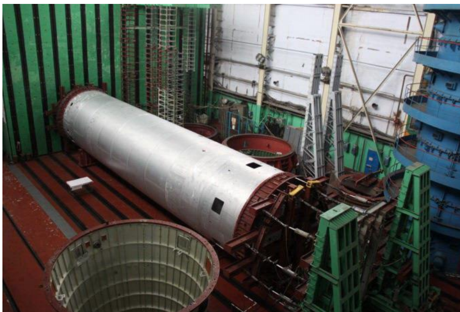
Рис. 2. Общий вид установки для испытаний на прочность стыка ступеней
