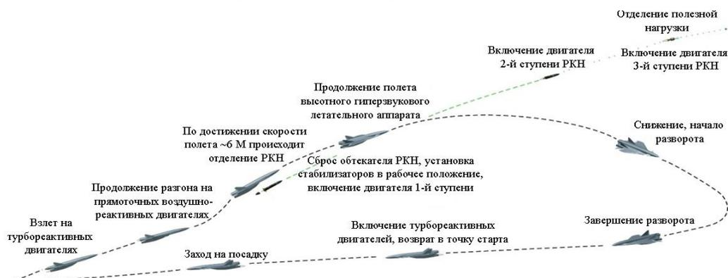
Рис. 1. Схема полета МТКС
