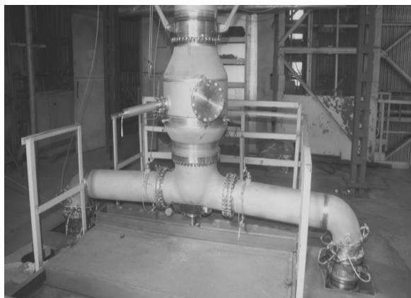
Рис. 4. Разделительный клапан с фрагментом расходной магистрали
