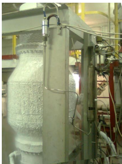
Рис. 3. Клапан при испытаниях на жидком кислороде
