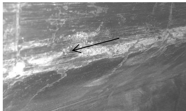
Рис. 8. Раковины в связующем с оголением углепластика (показано стрелкой)
