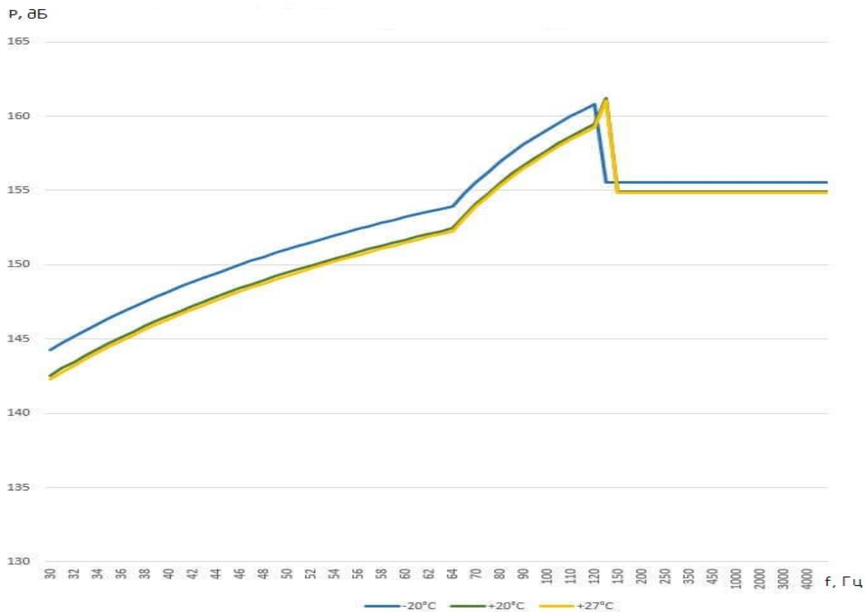
Рис. 1. График изменения звукового давления в зависимости от частоты вблизи зоны полезного груза
