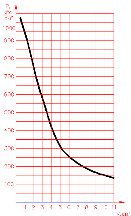
Рис. 7. График зависимости давления P от объема рабочей камеры V для пиропатрона ДИШВ.773924.406-01
