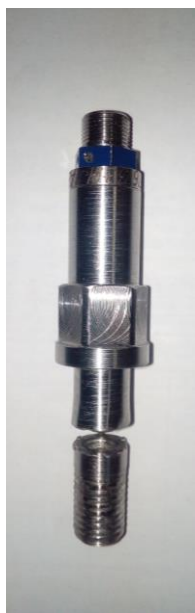
Рис. 9. Части пироболта срезного типа с сегментами после срабатывания
