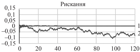
Рис. 14. Кут рискання, який отримано згідно з (5) (лінія 1) та за методом Рунге-Кутта (лінія 2) (напрямок осі Y_1 протилежний напрямку дії сили тяжіння)
