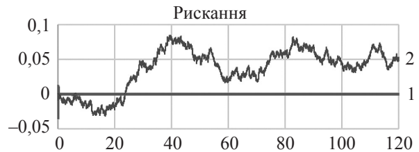
Рис. 20. Кут рискання, який отримано згідно з (5) (лінія 1) та за методом Рунге-Кутта (лінія 2) (напрямок осі Z_1 протилежний напрямку дії сили тяжіння)
