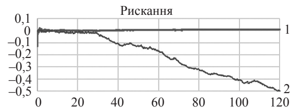
Рис. 11. Кут рискання, який отримано згідно з (5) (лінія 1) та за методом Рунге-Кутта (лінія 2) (напрямок осі X_1 збігається з напрямком дії сили тяжіння)
