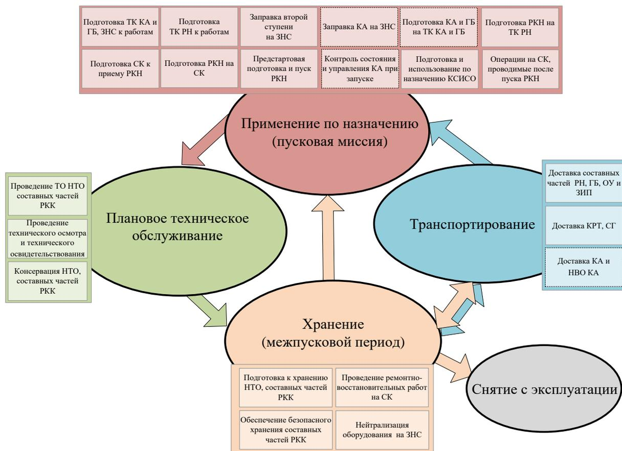
Схема эксплуатации РКК «Циклон-4М»:
