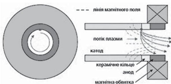
Рис. 3. Двигун \mu SAT з кільцевим електродом: вид спереду з круговим рухом плями дуги під впливом магнітного поля (ліворуч); вид збоку (праворуч)
