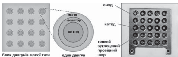
Рис. 10. Кластер тонкошарових ВДРД: схема масиву двигунів (ліворуч); зображення складеного двигуна ALPS (праворуч)
