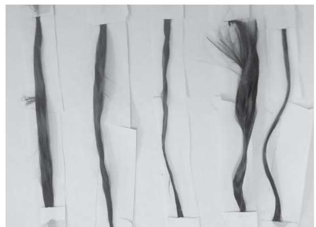
Рис. 3. Зразки вуглецевого джгута: а – вихідний до випробування; б – вихідний після випробування; в – розмотаний із трубчастої конструкції до випробування; г – розмотаний із трубчастої конструкції після випробування
