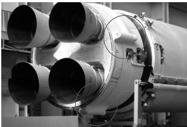
Рис. 2. Розміщення РДТП на хвостовому відсіку першого ступеня
