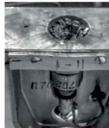
Рис. 2. Місце встановлення розривного болта РБ16М у шпангоуті міжступеневого відсіку РН «Циклон-4»
