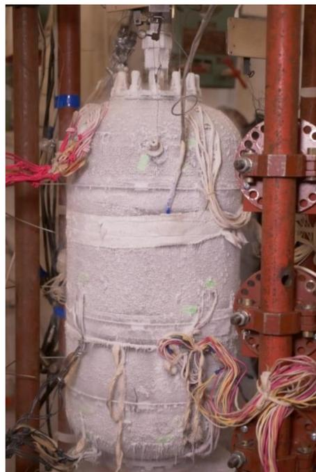
Рис. 7. ТБ при испытаниях жидким азотом
